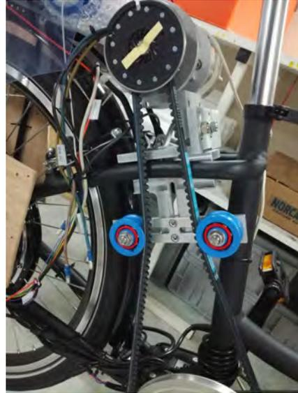
FIGURE 16: Génératrice du prototype N1
