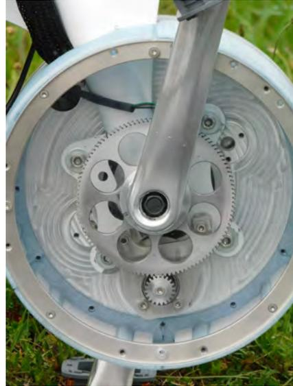
FIGURE 18: Génératrice du prototype N2
