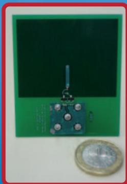
Ce dispositif est constitué d'une antenne patch 50 ohms à 2.45 GHz et d'un convertisseur AC-DC à haut rendement.
